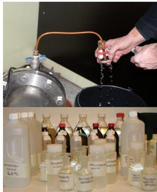
Kuva: Manuaalinen veden näytteenotto/analysointi kerran kuukaudessa ei ole riittävää
